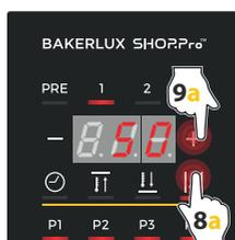
пример отвода влажности на 50% в печи версии DECK
